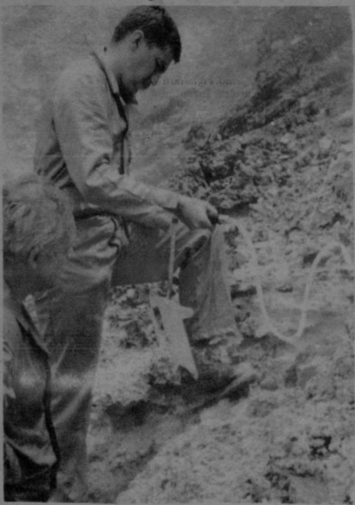
Con éstos extraños receptáculos y tubos de material especial, los científicos de la Universidad Nacional han seguido obteniendo muestras de gases del fondo de los cráteres volcánicos del país para analizar sus componentes químicos. También se recogen aguas, rocas, compuestos lávicos y cenizas.
